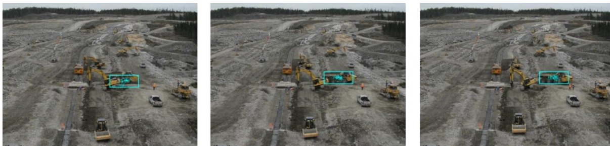
Slika 5. Primjer praćenja zglobnog dampera (preuzeto i uređeno: Zhu i dr., 2016)
