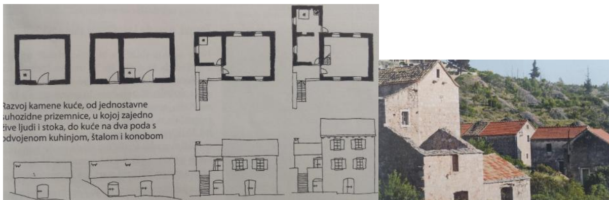
Slike 34.-35. Razvoj kamene kuće, od jednostavne suhozidne prizemnice u kojoj zajedno žive ljudi i stoka, do kuće na dva poda s odvojenom kuhinjom, štalom i konobom (lijevo) 7 ; Velo Grablje na otoku Hvaru - jednostavni sklopovi suhozidnih kućica vremenom su izrasli u velika utvrđena zidana sela sa kućama katnicama (desno) 7
