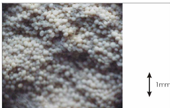
Slika 14. SEM 1 snimka oolitične strukture tenelije
