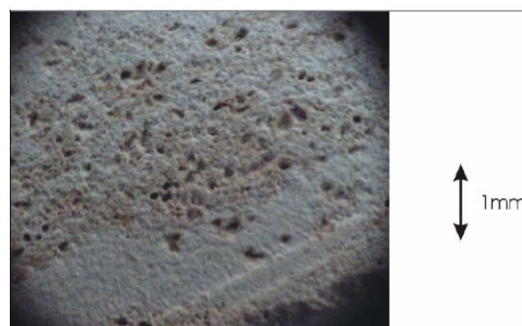
Slika 15. SEM 1 snimka sitnozrnate strukture miljevine
