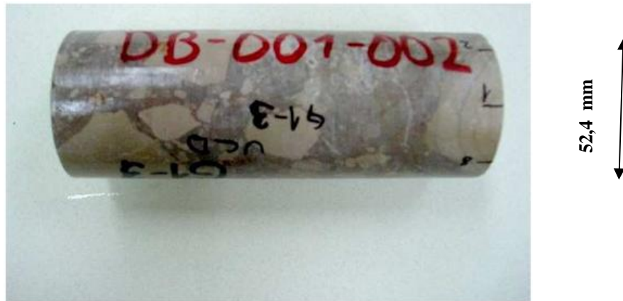
Slika 4. Uzorak oznake DB-001-002 pripremljen za ispitivanja fizičko-mehaničkih svojstava
