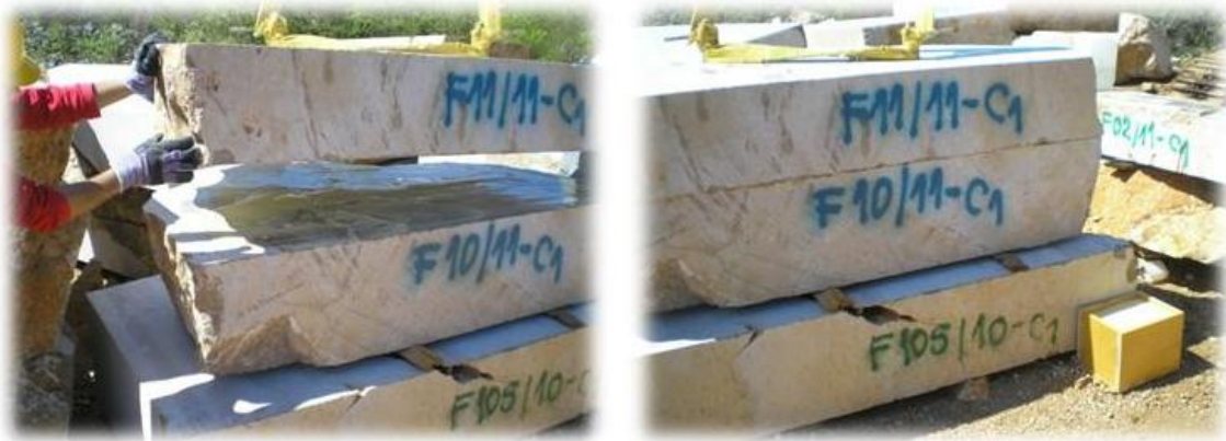
Slika 2. Nanošenje jedan fešte na drugu preko tankog sloja vezivne smole
