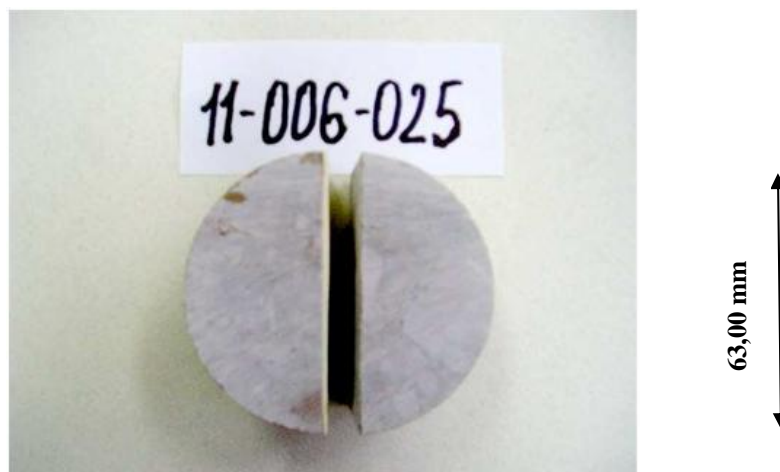
Slika 5. Uzorak zalijepljenog kamena oznake 11-006-025 nakon ispitivanja vlačne čvrstoće
