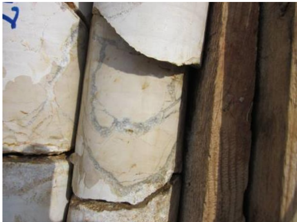
Slika 22. Brečasta struktura vapnenca
