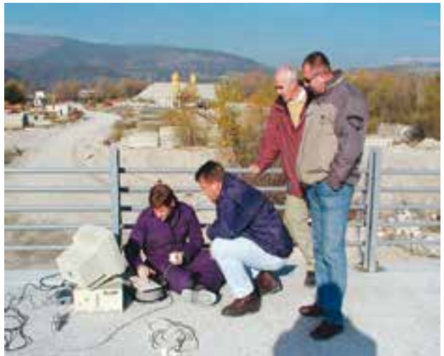
Mjerenje ubrzanja pri dinamičkom ispitivanju mosta
