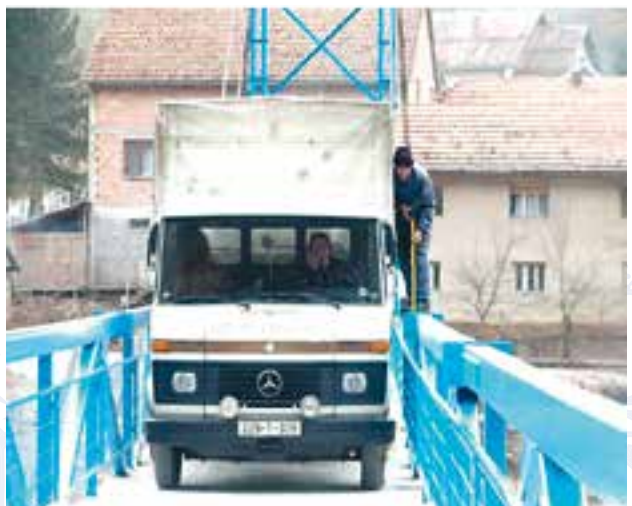
Mjerenje progiba pri ispitivanju mosta
