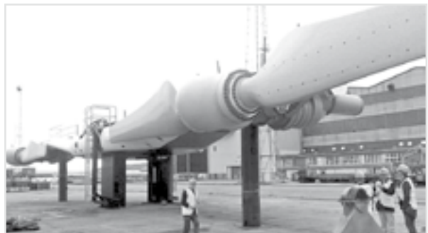
Prototip turbine nekonvencionalne plimne elektrane
