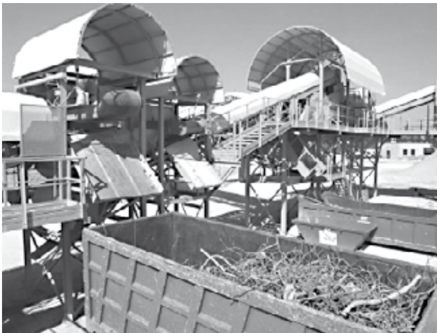
Sl..1: Magnetski separator na nepokretnom postrojenju za recikliranje u Pisi u Italiji. Magnetični otpad je uporabljen u sekundarne metalne sirovine.
