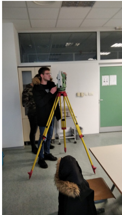
Slika 4.6. Svladavanje postupka centriranja i horizontiranja elektroničkog tahimetra
